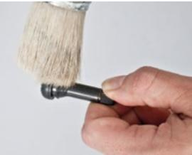
Ventil mit Seifenwasser oder einer Montagepaste einstreichen, um Beschädigungen an der Ventiloberfläche bei der Montage zu vermeiden.
