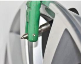
Ventil mit Standard Einziehhelbel, in axialer Richtung zur Ventilbohrung, behutsam einziehen – Ventil nicht verkanten oder überdehnen.
