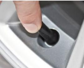
Ventiloberfläche auf Beschädigungen und Risse untersuchen.
