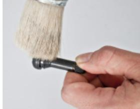
Ventil mit Montagepaste einstreichen, um Beschädigungen an der Ventiloberfläche bei der Montage zu vermeiden.
