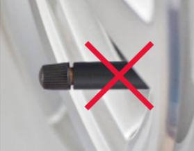
Das Ventil muss für den Felgenlochdurchmesser geeignet sein.
