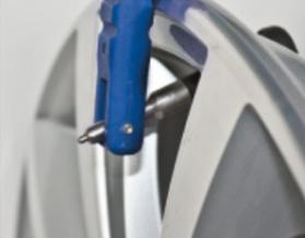
Ventil mit Standard Einziehhebel, in axialer Richtung zur Ventilbohrung, behutsam einziehen - Ventil nicht verkanten oder überdehnen.
