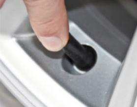
Ventiloberfläche auf Beschädigungen und Risse untersuchen.
