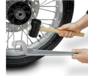
Die Steckgewichte für Speichenräder werden mit dem Einschlagwerkzeug 385/1 von HOFMANN POWER WEIGHT auf den Speichennippel aufgeschlagen. Nur so lassen sich Montagefehler vermeiden. Mit diesem Werkzeug wird die erforderliche Kraft für eine sichere und exakte Klemmung des Gewichts übertragen. Eine Montage mit anderen Werkzeugen oder die Verwendung von Gewichten, die nur mit einer Zange zusammengedrückt werden, kann im Fahrbetrieb dazu führen, dass sich die Gewichte lösen.
