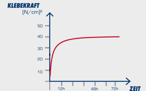
24 Stunden nach der Montage werden 90% der Endklebekraft erreicht. Die Endklebekraft wird nach ca. 72 Stunden erreicht.
