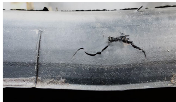
SCHADEN AN DER WULST durch zu hohe Spannung beim Entfernen des Montagefingers. Vermeidbar durch ausreichend geeignete Gleitmittel & fachgerechte Montage. (Bild: wdk)
