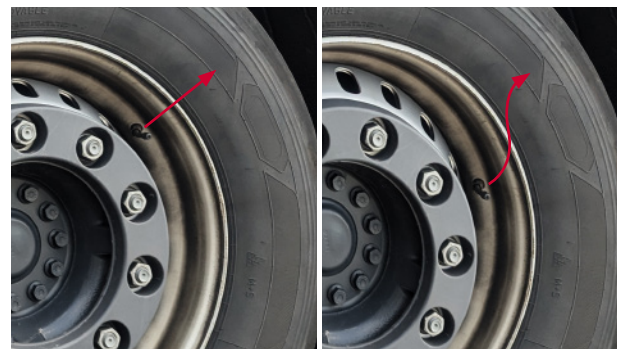
DER REIFEN VERDREHT SICH AUF DER FELGE aufgrund unzureichender Trocknung.
