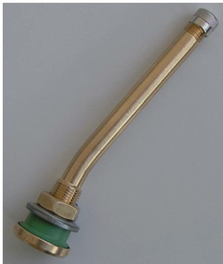
Vor allem bei **hohen Umgebungstemperaturen** sind Ventile von Fahrzeugen, die im **Stop-and-Go** Verkehr eingesetzt werden (z. B. bei Müllabfuhr, Auslieferungsfahrten, Paketdiensten) teilweise extremen Beanspruchungen ausgesetzt. Durch ständiges **Beschleunigen** und **Abbremsen** entstehen **hohe Temperaturen** in Reifen, Rad und Ventil, die schnell zu Luftverlust oder Komplettausfall des Ventils führen können.
