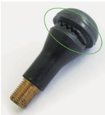
Überaltertes, abgerissenes Ventil
