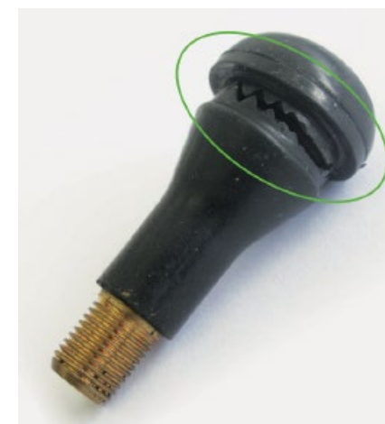
Überaltertes, abgerissenes Ventil
